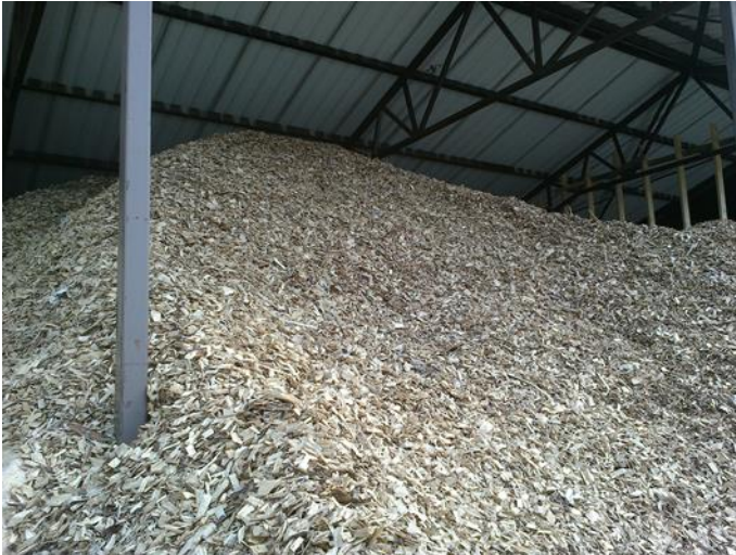
Kuva 2: Metsähaketta lämpölaitoksella varastoituna
